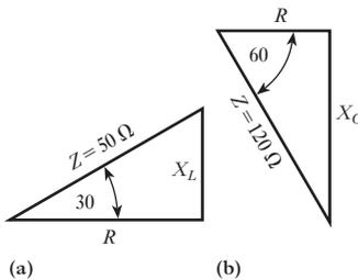
**Fig. 12.9** Impedance triangles for Example 12.2(c) and (d)
